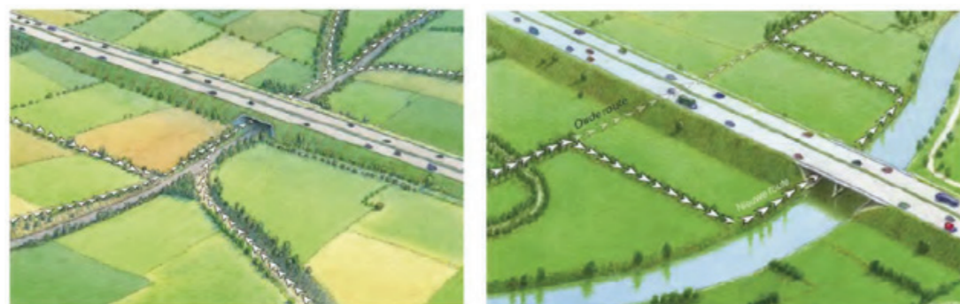
Figuur 24: Voorbeelden van passeerbare bruggen onder een weg, met en zonder watergang (bron: brochure Met vleermuizen overweg).
