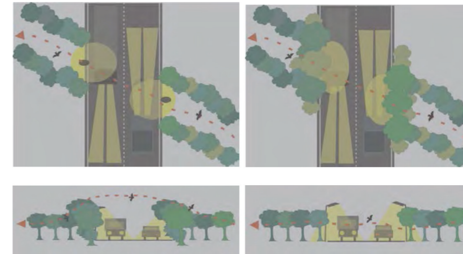
Figuur 21: Voorbeeld van mitigeren van licht door een hop-over (bron: Herman Limpens, Zoogdierverseniging).
