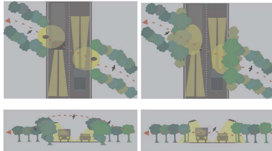
Figuur 12: Voorbeeld van mitigeren van licht door een hop-over (bron: Herman Limpens, Zoogdierverseniging).
